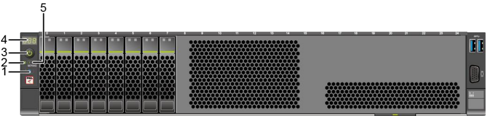
图 5-11 8x2.5 英寸硬盘配置前面板指示灯和按钮
