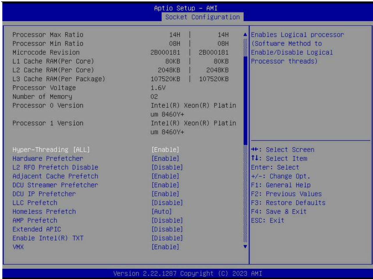
图 3-5-3 Processor Configuration 界面
