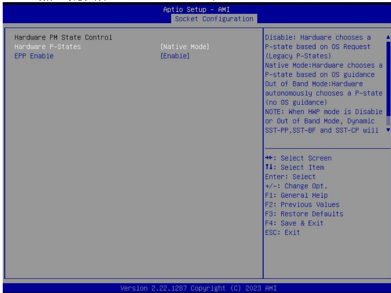
图 3-5-18 Hardware PM State Control 界面
